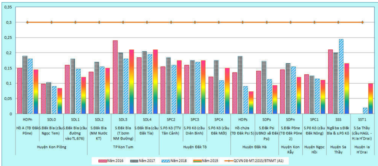
Diễn biến thông số NH 4 + trong nước mặt mùa khô giai đoạn 2016 – 2019
